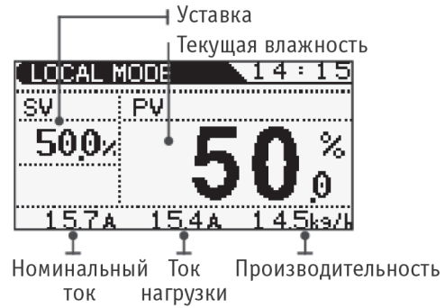
E. Режим местного ВКЛ/ВЫКЛ с датчиком влажности
