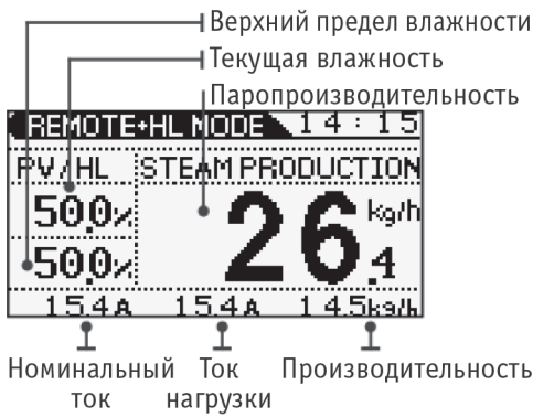
D. Режим дистанционного пропорционального управления с датчиком верхнего предела
