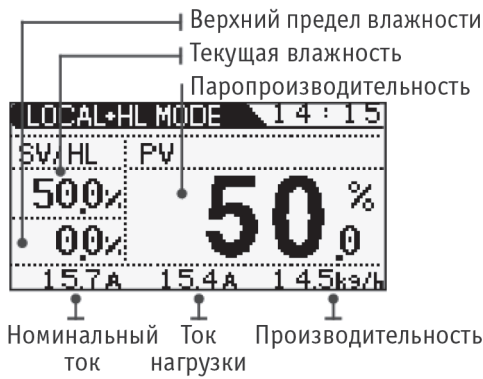
F. Режим местного ВКЛ/ВЫКЛ с датчиком контроля влажности и датчиком верхнего предела (границы) влажности
